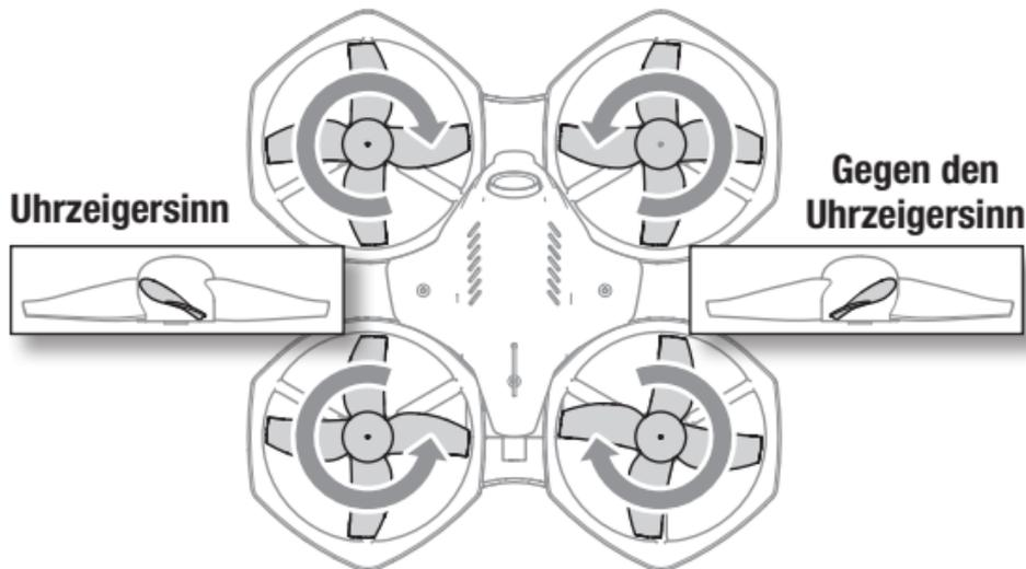
2. Die Propeller sind per Presspassung auf den Motorwellen angebracht. Die Propeller durch Ziehen der mittleren Nabe gerade weg vom Motor entfernen.
