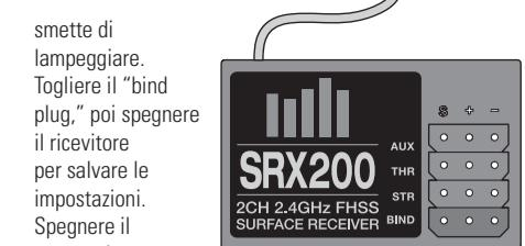
smette di lampeggiare. Togliere il "bind plug," poi spegnere il ricevitore per salvare le impostazioni. Spegnere il trasmittitore. Togliere il connettore "bind plug" e riporlo in un luogo sicuro.
